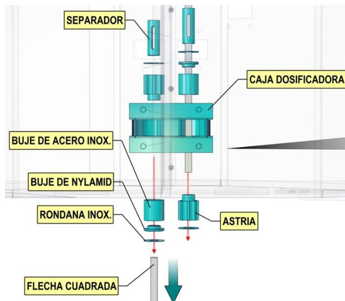
8. Para quitar las cajas dosificadoras, retire los tornillos hex. 1/4". En la parte interna del depósito sostenga los tornillos, otra persona que retire las tuercas por la parte inferior.
