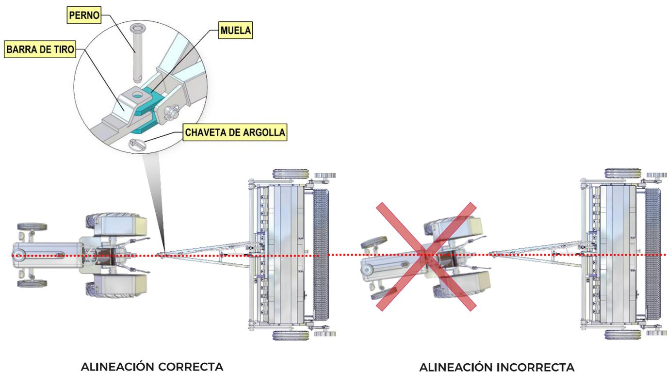
4. Mantenga en posición horizontal su equipo tal como se muestra en la siguiente figura para poder realizar un enganche correcto a la barra de tiro.
