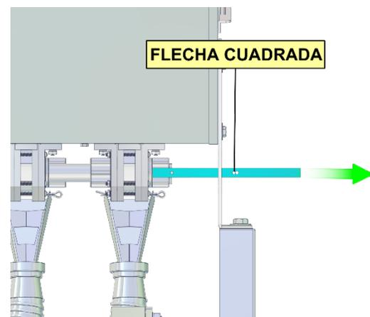
7. Conforme vaya sacando la flecha, vaya retirando todos los componentes.
