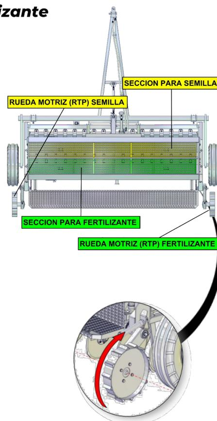
9. Una vez terminada la calibración de semilla realice los pasos 3, 4, 5 y 6 para calibrar el fertilizante.
