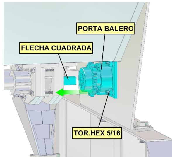
6. Para sacar la flecha solo jale hacia afuera, cuidando de no dañar componentes de las cajas dosificadoras.
