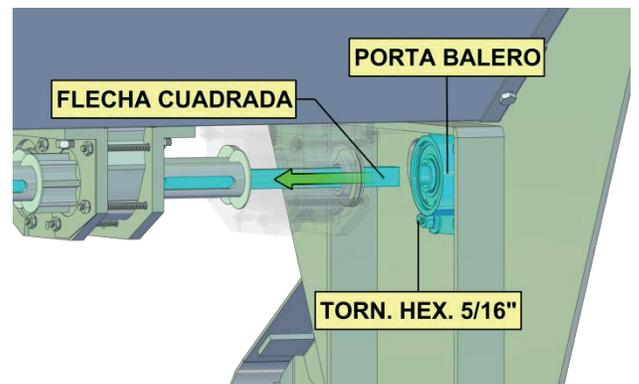
7. Para sacar la flecha solo jale hacia afuera, cuidando de no dañar los componentes de las cajas dosificadoras.
